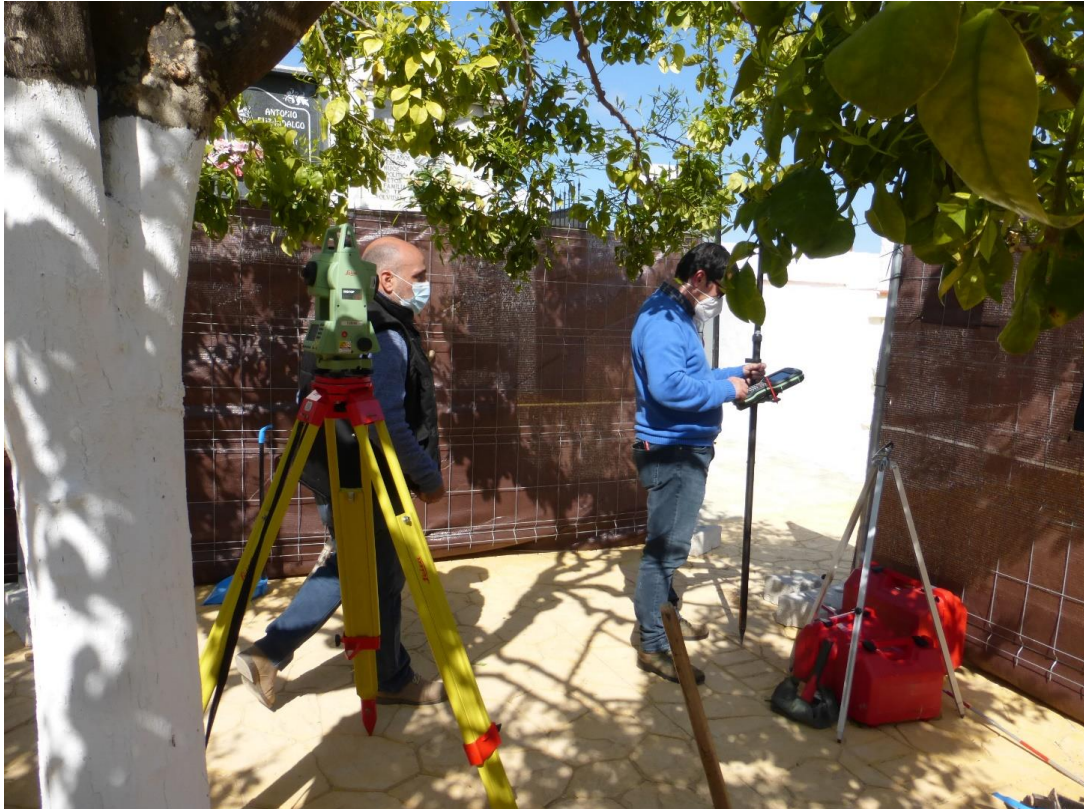
Posicionamiento de la estación total y toma de datos para la georreferenciación de los sondeos realizados y de la documentación obtenida. Realizado por el Departamento de Ingeniería Gráfica, Área de Expresión Gráfica en la Ingeniería, Universidad de Sevilla.
