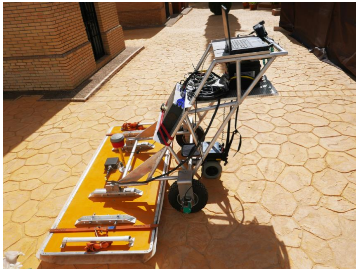
Figura 3. Equipo usado en este trabajo, la imagen muestra el equipo 3D-Radar DX ARRAY con una antena acoplada al terreno. El sistema multicanal es la plancha de color amarillo situada en la parte baja del carrito empujado por el vehículo eléctrico, la antena GNSS es el dispositivo de color rojo y gris ubicado sobre la antena (tiene además otro sistema GNSS interno). La consola de adquisición de datos se encuentra en la parte frontal del vehículo, la cual es controlada por un ordenador portátil ubicado en la parte superior del mismo.
